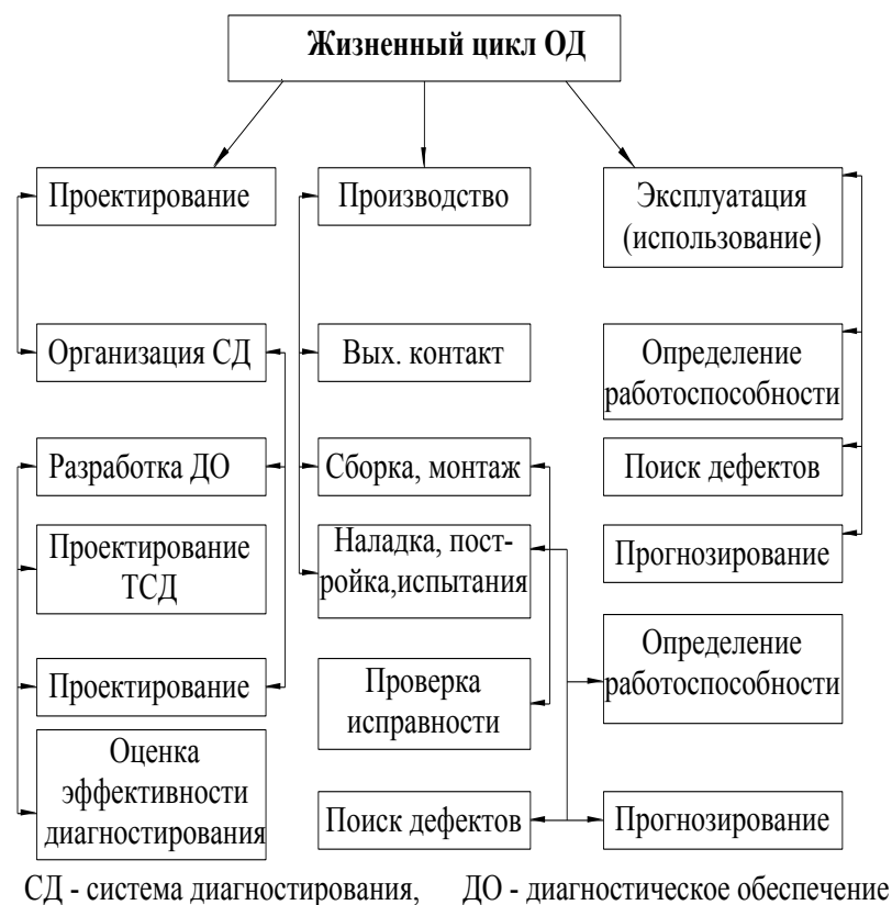
Рисунок 1 - Схема жизненного цикла объекта диагностирования СЭУ
