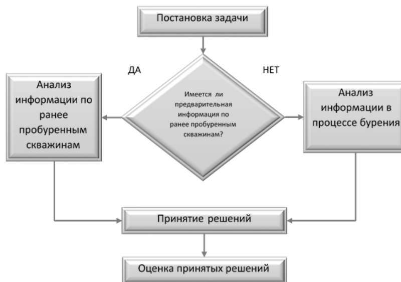
Рисунок 1 - Блок-схема принятия решений при бурении скважин в зависимости от характера исходной информации
