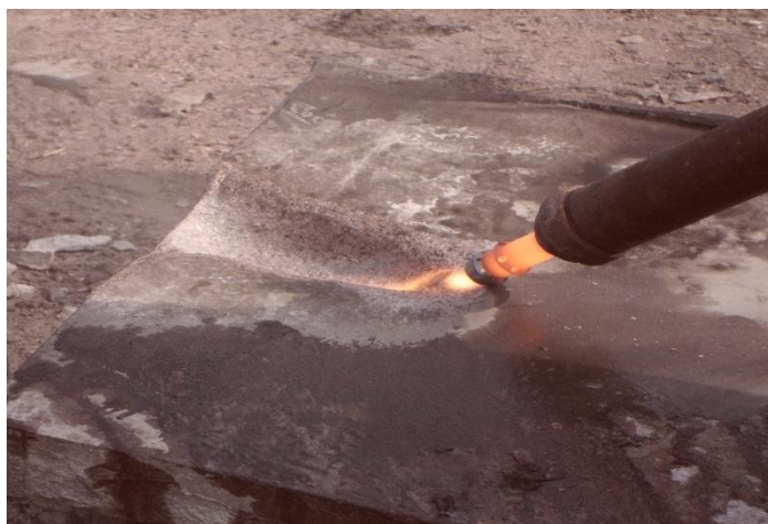
Рисунок 5 – Образование щелевой выработки факелом терморезака БВР60 с газодинамическим насадком
