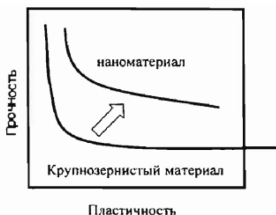
Рисунок 2 - Соотношению между прочностью и пластичностью для крупнокристаллических и нанокристаллических материалов
