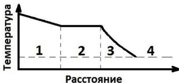
Рисунок 1 - Распределение температуры в пласте при нагнетании в него пара
