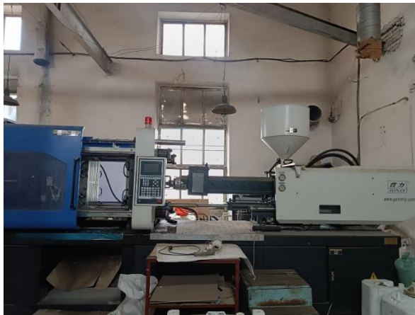
6 сурет. Балқыған пластиктен дайын өнім алу үшін құю машинасы, Пластикалық бұйымдарды құюға арналған жаңа термопластикалық машина.
