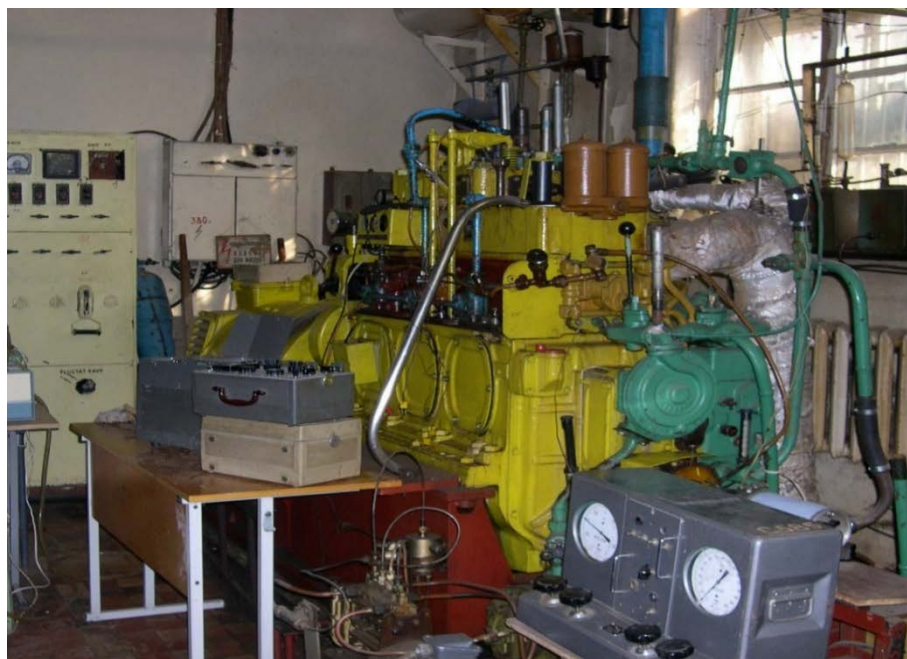
Рисунок 1 - Общий вид экспериментальной конструкции с дизелем 3Ч17,5/24.
