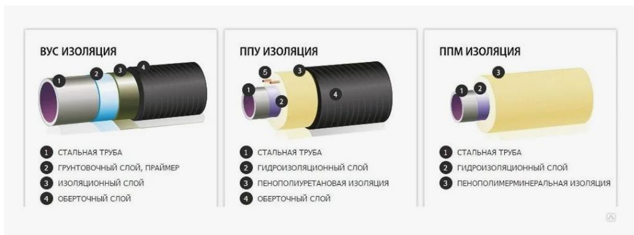
Рисунок 3. Виды многослойных полимерных покрытий
