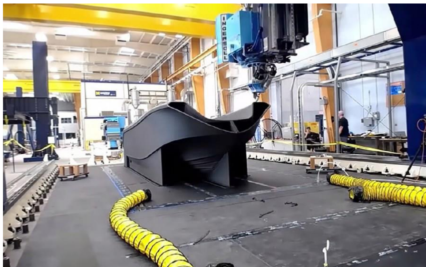
Рисунок 1 – Изготовление корпуса катера с помощью 3D-печати.
